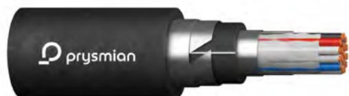
Eisenbahn-Signalkabel zur Ansteuerung von Lichtsignalen, Weichenantrieben oder ähnlichen Anwendungen. Geeignet für direkte Verlegung auf oder im Boden oder in Kabelkanälen und -trögen. Verbesserter mechanischer Schutz durch Stahlbandarmierung. Flammwidrig nach IEC 60332-1. Verseilmuster: n x 1 x 1,5 / 2,5 mm.
