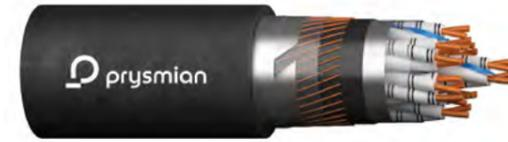
Eisenbahn-Signalkabel zur Ansteuerung von Achszählern oder ähnlichen Anwendungen, zur Übertragung von Daten über symmetrische Leitungskreise. Geeignet für direkte Verlegung auf oder im Boden oder in Kabelkanälen und -trögen. Zur Verlegung entlang elektrifizierter Strecken. Mit zusätzlichem Cu-Schirm gegen induktive Beeinflussung. Verbesserter mechanischer Schutz durch Stahlbandarmierung. Verseilmuster: n x 4 x 0,9 / 1,4 mm.
