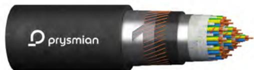
Modernes, kunststoffisoliertes TK-Kabel als Ersatz in neuen Installationen für alte Kabel mit F-, TF-, TFS- und Koaxialelementen nach DB 1.01.106. Geeignet für direkte Verlegung auf oder im Boden oder in Kabelkanälen und -trögen. Zur Verlegung entlang elektrifizierter Strecken. Mit zusätzlichem Cu-Schirm gegen induktive Beeinflussung. Verbesserter mechanischer Schutz durch Stahlbandarmierung. Verseilmuster: n x 4 x 1,4 + m x 4 x 0,9 mm.
