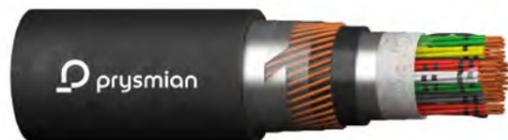
Bahnhof-Fernmeldekabel in Sternviererverseilung für Fernmelde- und Informationsverarbeitungsanlagen nach Deutsche Bahn AG TL 416.0531 v.1.0. Geeignet für direkte Verlegung auf oder im Boden oder in Kabelkanälen und -trögen. Mit zusätzlichem Cu-Schirm gegen induktive Beeinflussung. Verbesserter mechanischer Schutz durch Stahlbandarmierung.
