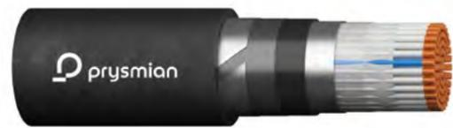
Eisenbahn-Signalkabel zur Ansteuerung von Lichtsignalen, Weichenantrieben oder ähnlichen Anwendungen. Geeignet für direkte Verlegung auf oder im Boden oder in Kabelkanälen und -trögen. Kabel mit verbesserter Betriebskapazität zur Reichweitenerhöhung. Verbesserter mechanischer Schutz durch Stahlbandarmierung. Verseilmuster: n x 1 x 1,4 / 1,8 mm.
