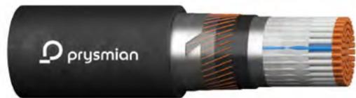
Eisenbahn-Signalkabel zur Ansteuerung von Lichtsignalen, Weichenantrieben oder ähnlichen Anwendungen. Geeignet für direkte Verlegung auf oder im Boden oder in Kabelkanälen und -trögen. Zur Verlegung entlang elektrifizierter Strecken. Mit zusätzlichem Cu-Schirm gegen induktive Beeinflussung. Verbesserter mechanischer Schutz durch Stahlbandarmierung. Verseilmuster: n x 1 x 0,9 mm.
