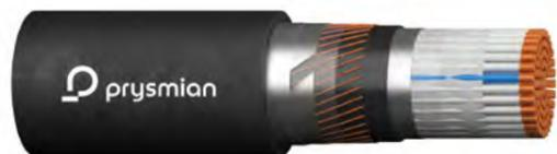
Eisenbahn-Signalkabel zur Ansteuerung von Lichtsignalen, Weichenantrieben oder ähnlichen Anwendungen. Geeignet für direkte Verlegung auf oder im Boden oder in Kabelkanälen und -trögen. Zur Verlegung entlang elektrifizierter Strecken. Mit zusätzlichem Cu-Schirm gegen induktive Beeinflussung. Verbesserter mechanischer Schutz durch Stahlbandarmierung. Verseilmuster: n x 1 x 1,4 / 1,8 mm.
