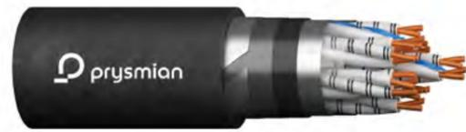
Eisenbahn-Signalkabel zur Ansteuerung von Achszählern oder ähnlichen Anwendungen, zur Übertragung von Daten über symmetrische Leitungskreise. Geeignet für direkte Verlegung auf oder im Boden oder in Kabelkanälen und -trögen. Verbesserter mechanischer Schutz durch Stahlbandarmierung. Verseilmuster: n x 4 x 0,9 / 1,4 mm.
