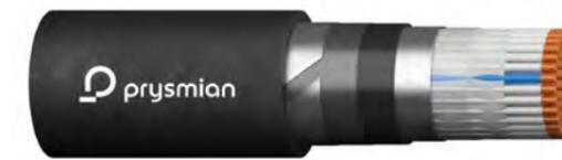
Eisenbahn-Signalkabel zur Ansteuerung von Lichtsignalen, Weichenantrieben oder ähnlichen Anwendungen. Geeignet für direkte Verlegung auf oder im Boden oder in Kabelkanälen und -trögen. Verbesserter mechanischer Schutz durch Stahlbandarmierung. Verseilmuster: n x 1 x 1,4 / 1,8 mm.
