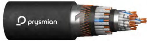
Kombiniertes Eisenbahn-Signalkabel zur Übertragung von Daten aus Achszählerkreisen über symmetrische Leitungskreise gemeinsam mit Adern zur Energieübertragung für Lichtsignale, Weichenantriebe oder ähnliche Anwendungen. Verbesserter mechanischer Schutz durch Stahlbandarmierung. Zur Verlegung entlang elektrifizierter Strecken. Mit zusätzlichem Cu-Schirm gegen induktive Beeinflussung. Verseilmuster: n x 4 x 0,9 / 1,4 + m x 1 x 1,4 / 1,8 mm.
