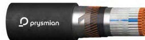
Eisenbahn-Signalkabel zur Ansteuerung von Lichtsignalen, Weichenantrieben oder ähnlichen Anwendungen. Geeignet für direkte Verlegung auf oder im Boden oder in Kabelkanälen und -trögen. Kabel mit verbesserter Betriebskapazität zur Reichweitenerhöhung. Zur Verlegung entlang elektrifizierter Strecken. Mit zusätzlichem Cu-Schirm gegen induktive Beeinflussung. Verbesserter mechanischer Schutz durch Stahlbandarmierung. Verseilmuster: n x 1 x 1,4 / 1,8 mm.
