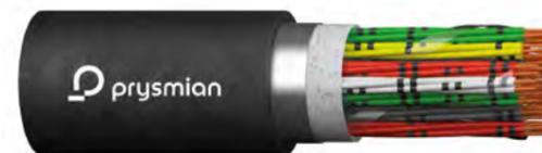
Bahnhof-Fernmeldekabel in Sternviererverseilung für Fernmelde- und Informationsverarbeitungsanlagen nach Deutsche Bahn AG TL 416.0531 v.1.0. Geeignet für direkte Verlegung auf oder im Boden oder in Kabelkanälen und -trögen.
