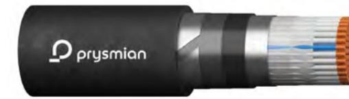
Eisenbahn-Signalkabel zur Ansteuerung von Lichtsignalen, Weichenantrieben oder ähnlichen Anwendungen. Geeignet für direkte Verlegung auf oder im Boden oder in Kabelkanälen und -trögen. Verbesserter mechanischer Schutz durch Stahlbandarmierung. Verseilmuster: n x 1 x 0,9 mm.
