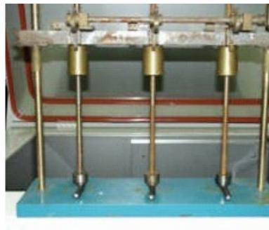
Testgerät für Kältebeständigkeit.
