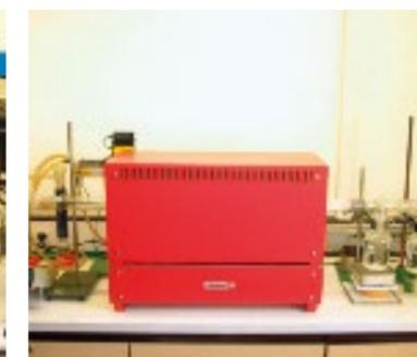
Messgeräte für Gas-Korrosion (halogenfrei).
