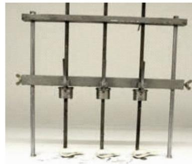
Testgerät für Kältebiegung.
