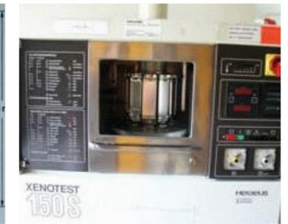
Testkammer für UV-Test.
