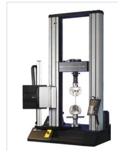
Test-Gerät für Zugbelastung.
