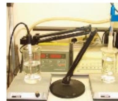
Messgeräte für Lichtdurchlässigkeit und pH-Wert (halogenfrei).
