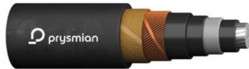
Verteilungskabel. Kann direkt in der Erde, in Rohren, im Freien, in Innenräumen sowie im Wasser verlegt werden. Ein längswasserdichter Schirmbereich kann bei evtl. Schäden an der Außenummantelung das Eindringen von Wasser an der Fehlerstelle begrenzen.
