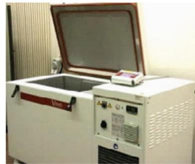
Prüfkammer (Temperaturbereich von -70 °C bis +80 °C).
