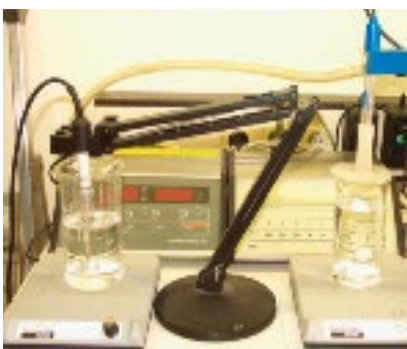
Messgeräte für Lichtdurchlässigkeit und pH-Wert (halogenfrei).
