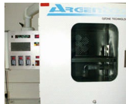
Testkammer für Ozon-Test.
