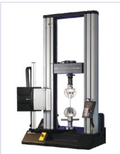
Test-Gerät für Zugbelastung.
