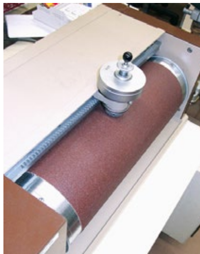
Testgerät mit Schleifpapier.
