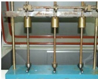
Testgerät für Kältebeständigkeit.
