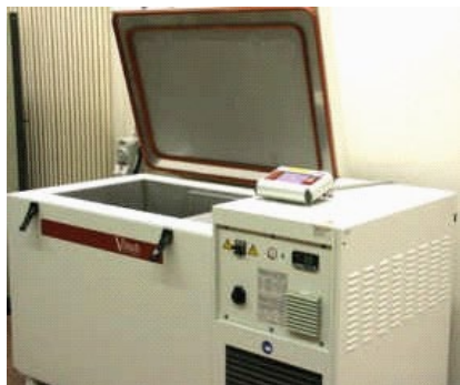
Prüfkammer (Temperaturbereich von -70°C bis +80°C).
